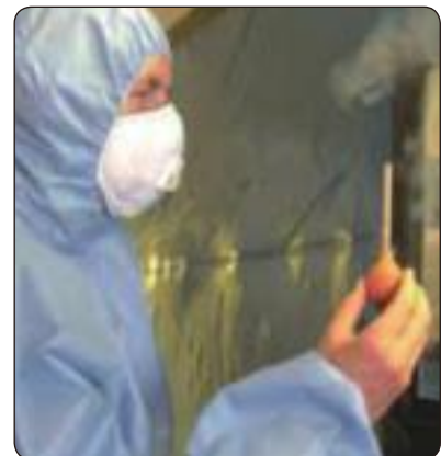
[그림 7-8] 발연관을 이용한 밀폐 적정유무 확인방법
