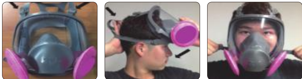
① 머리 및 턱 끈을 느슨하게 함 ② 머리끈을 잡고 착용 ③ 턱 및 머리순서로 끈을 당겨 조절
