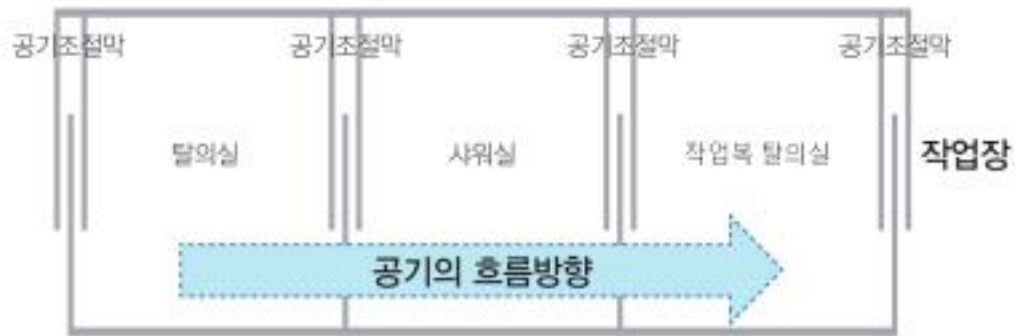
[그림 5-8] Z-LOCK의 설치 방법
