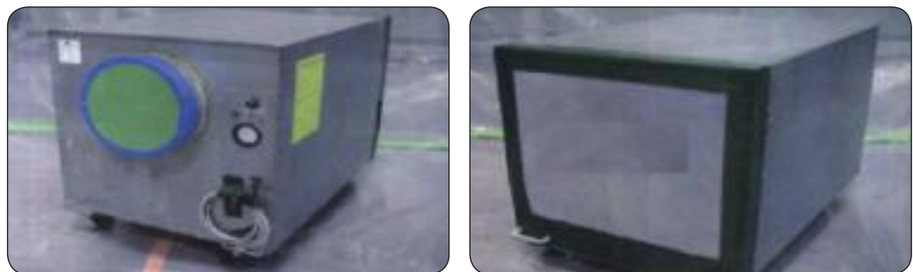
[그림 4-7] 음압기의 배기구(좌) 및 흡입구(우)의 밀봉 예
