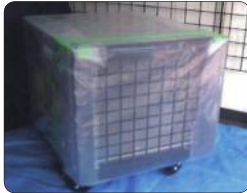
[그림 4-8] 이동 및 보관시 음압기 밀봉 예
