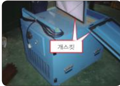
[그림 4-3] 공기누설 방지를 위한 개스킷 설치 예
